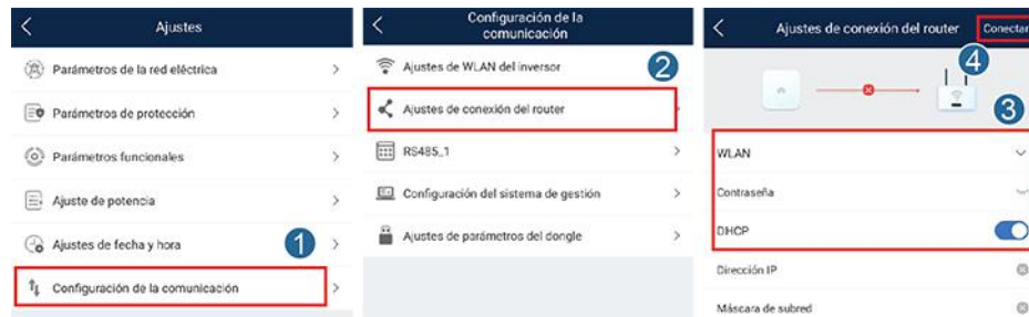
Figura C-2 Configuración de los parámetros del router
