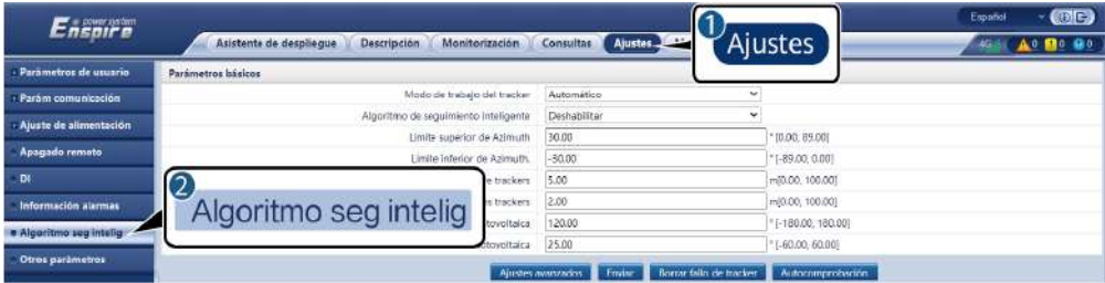
Figura 6-41 Parámetros del algoritmo de seguimiento inteligente (SDS)
