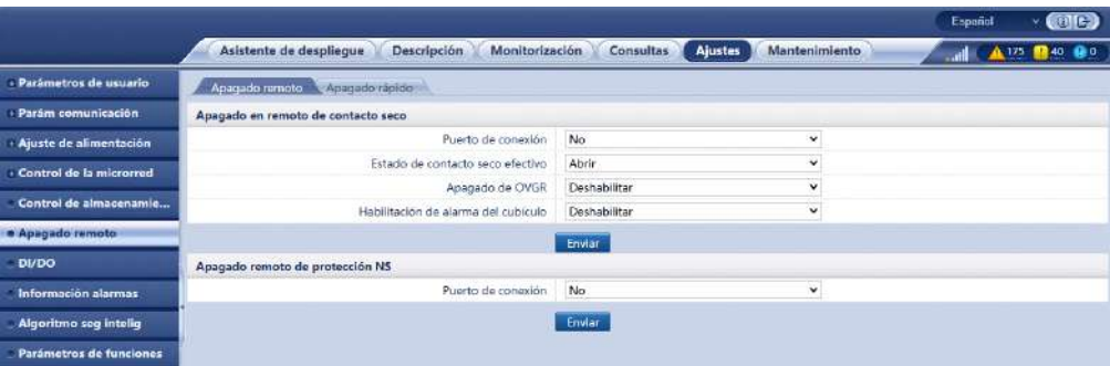
Figura 6-59 Apagado remoto de protección NS
