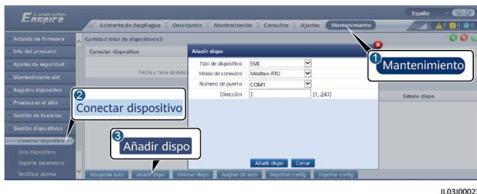
Figura 6-36 Configuración de los parámetros de acceso
