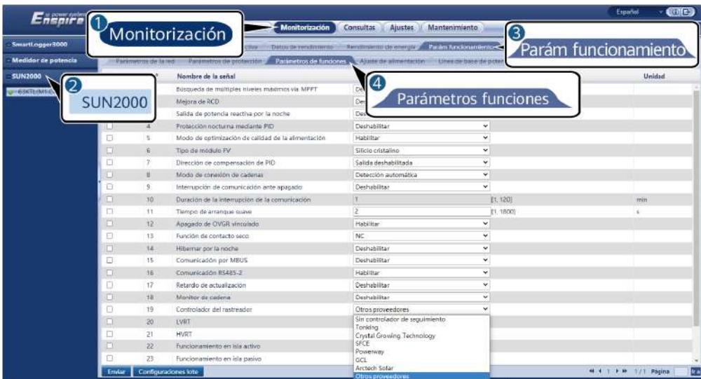
Figura 6-30 Configuración del controlador del sistema de seguimiento
