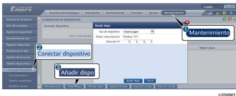
Figura 6-22 Configuración de los parámetros de acceso
