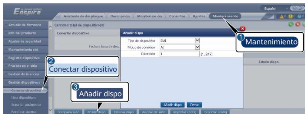
Figura 6-37 Configuración de los parámetros de acceso
