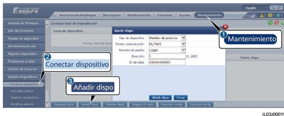
Figura 6-34 Configuración de los parámetros de acceso
