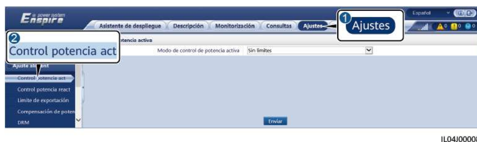
Figura 6-46 Control de potencia activa
