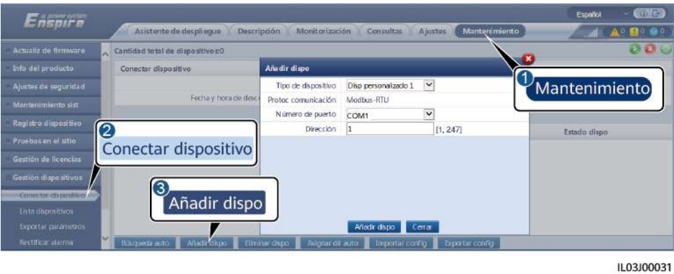
Figura 6-39 Configuración de los parámetros de acceso
