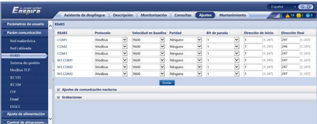
Figura 6-20 Configuración de los parámetros de RS485
