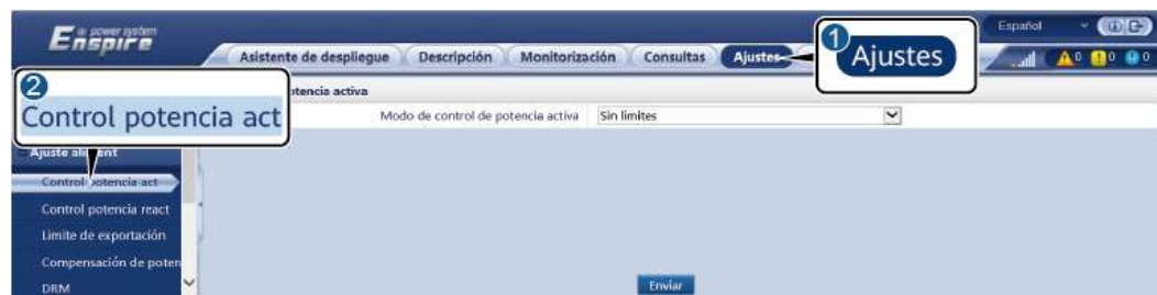
Figura 6-71 Control de potencia activa
