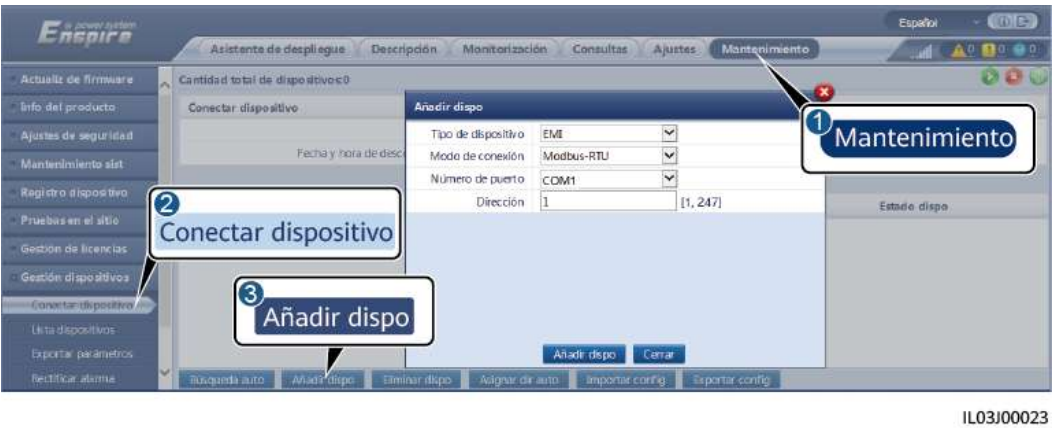
Figura 6-54 Configuración de los parámetros de acceso
