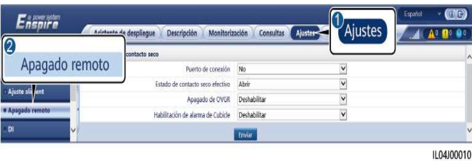
Figura 6-84 Apagado remoto de protección NS
