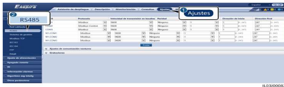
Figura 6-85 Configuración de los parámetros de RS485
