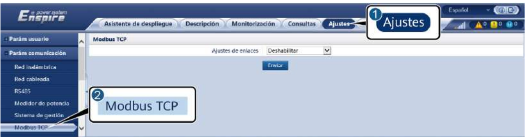
Figura 6-32 Configuración de los parámetros de Modbus TCP
