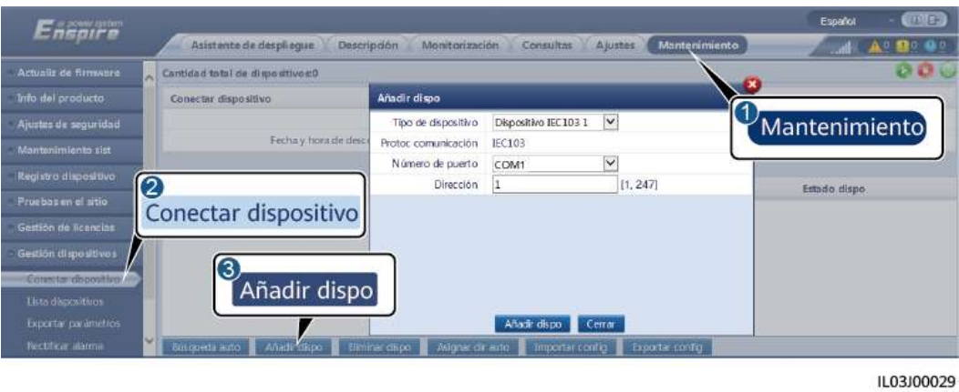
Figura 6-61 Configuración de los parámetros de acceso
