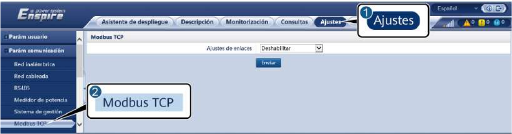
Figura 6-39 Configuración de los parámetros de Modbus TCP
