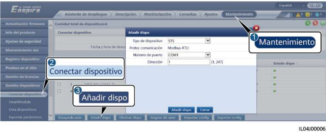
Figura 6-57 Configuración de los parámetros de acceso
