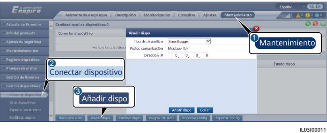
Figura 6-40 Configuración de los parámetros de acceso
