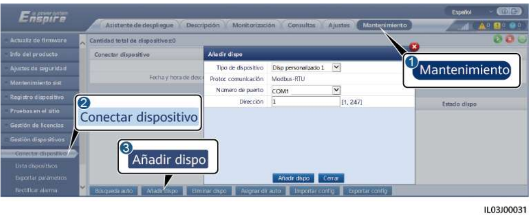
Figura 6-64 Configuración de los parámetros de acceso
