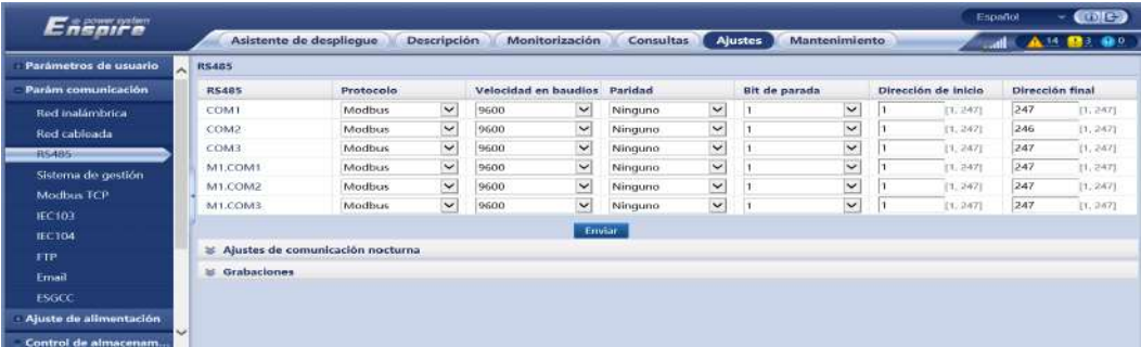
Figura 6-38 Configuración de los parámetros de RS485
