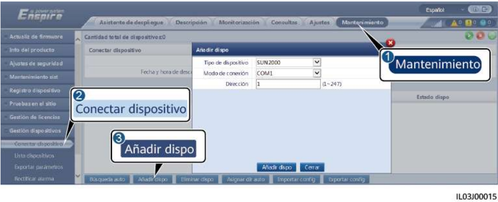
Figura 6-47 Configuración de los parámetros de acceso
