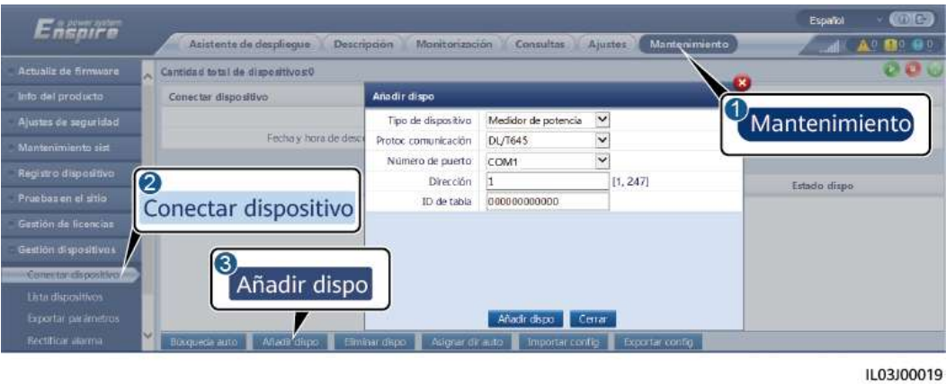
Figura 6-52 Configuración de los parámetros de acceso
