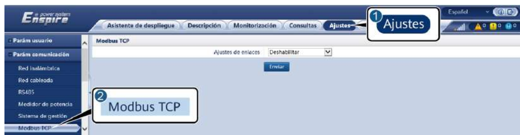
Figura 6-36 Configuración de los parámetros de Modbus TCP
