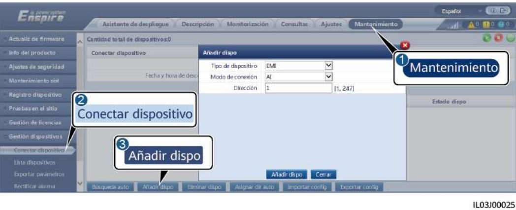
Figura 6-55 Configuración de los parámetros de acceso
