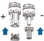
Figura 5-19 Tapones de sellado con encastrados a presión
