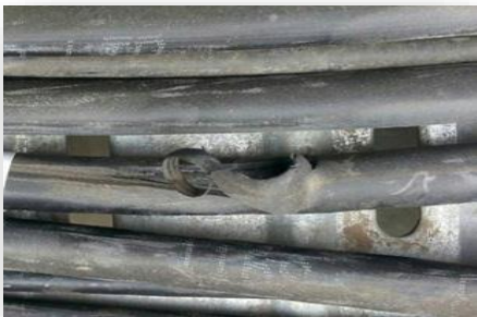
DC cable breakage
