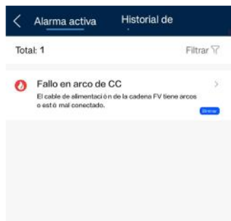
Figura 7-2 Eliminación de la alarma
