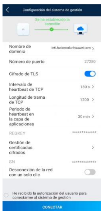
Figura 7-6 Desconexión de la red con un solo clic (usando como ejemplo al usuario instalador en el escenario de conexión directa del inversor)
