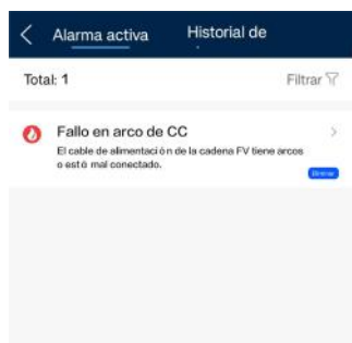
Figura 7-8 Eliminación de la alarma
