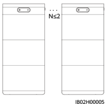
Figura 2-5 Conexión en paralelo
