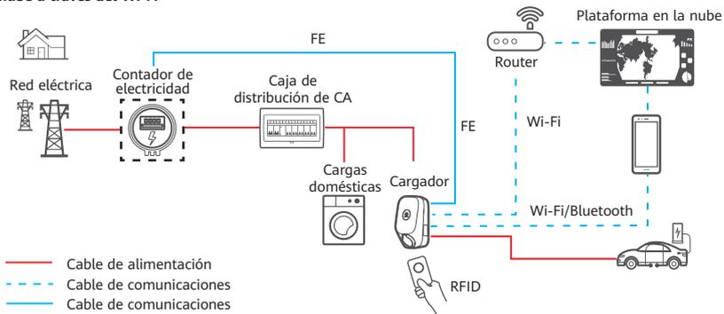
Figura 2: Cargador conectado al contador a través del puerto FE y no conectado a la plataforma en la nube
