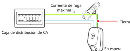
5. Inserte el conector de carga en el cargador e inicie la sesión de carga. Utilice el mismo método para medir la corriente de fuga máxima del cable de tierra aguas arriba  $I_B$ .
