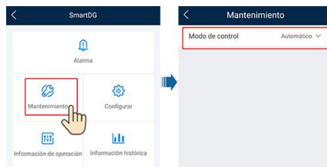
Figura 6-13 Configuración del modo de control del generador
