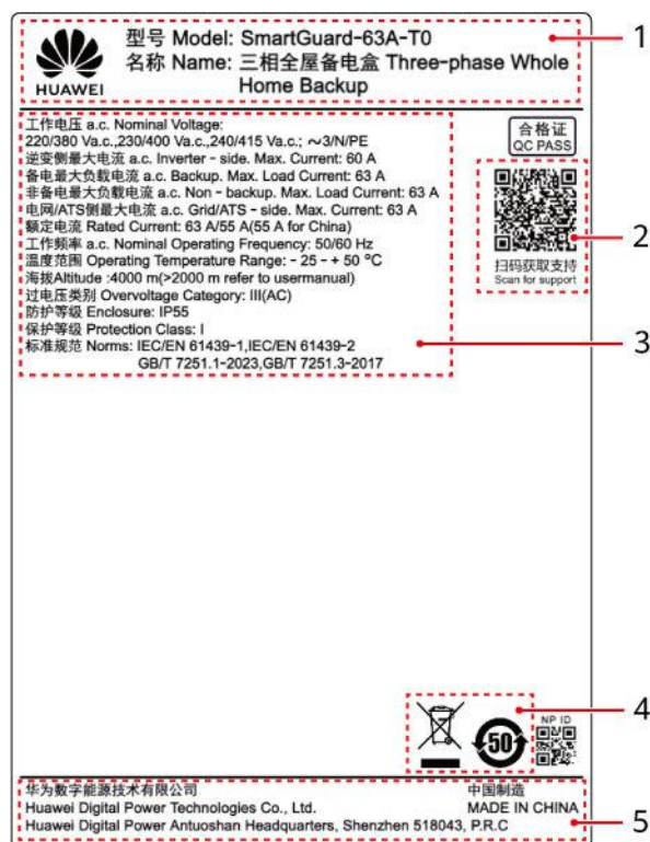
Figura 2-12 Placa de identificación (se usa como ejemplo el dispositivo SmartGuard-63A-T0)
