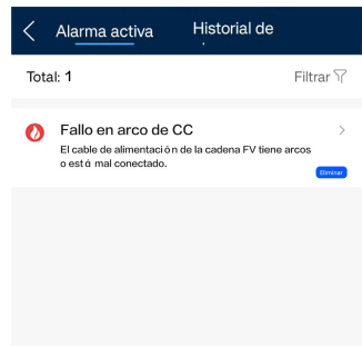
Figura 7-2 Eliminación de la alarma
