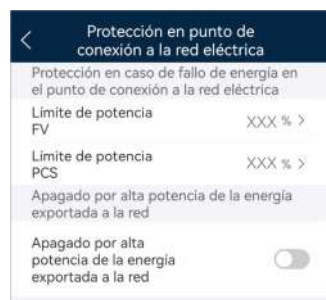
Figura 10-11 Protección en el punto de conexión a la red eléctrica
