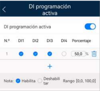
Figura 10-2 Planificación de potencia activa por DI
