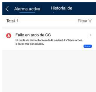
Figura 7-13 Eliminación de la alarma
