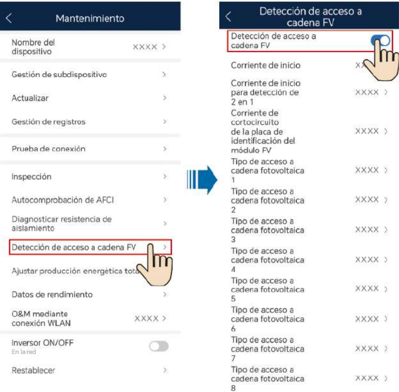
Figura 7-11 Detección de acceso a los strings FV
