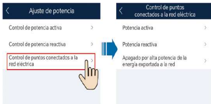
Figura 7-7 Control del punto de conexión a la red eléctrica
