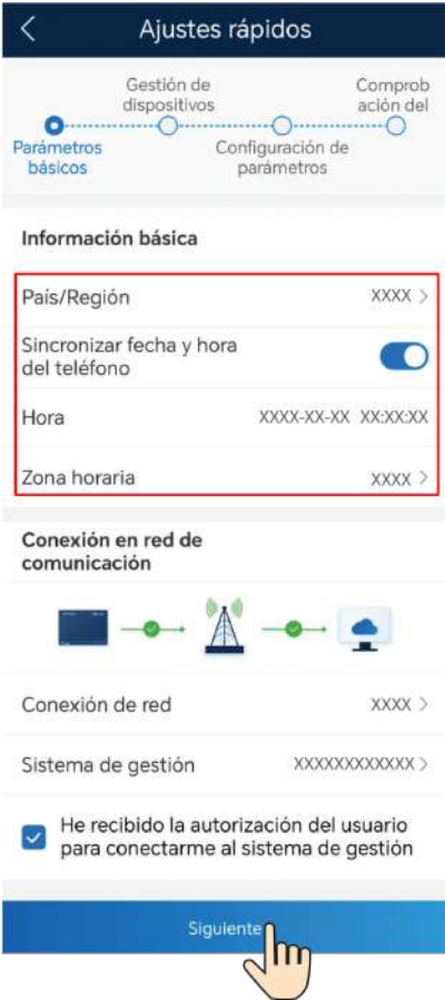
Figura 7-6 Parámetros básicos (usando como ejemplo la conexión a red del SmartLogger5000B)
