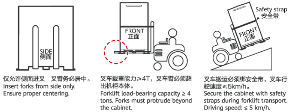
Figura 3-1 Requisitos de carga y descarga
